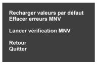
L'option "Reload factory defaults" ne doit pas être utilisée, à moins qu'un technicien ne le conseille. Toutes les valeurs par défaut sont alors rechargées dans le dôgre et l'ensemble des données préalablement stockées sont effacées (telles que prépositionnements, heure et date, etc.).
